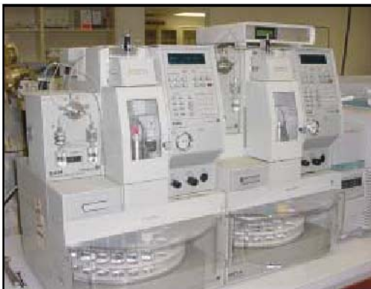
图 9 OI 分析仪器公司的双吹扫捕集系统采用 PT Express 和 SAM
