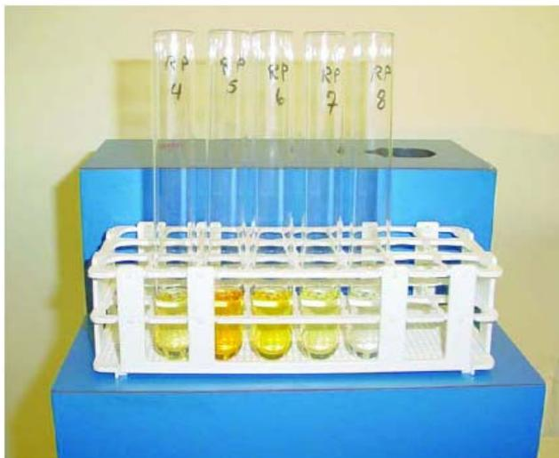
图5 采用一根填充了60克 Envirobeads SX-3 的玻璃 GPC 柱, 1: 1 的乙酸乙酯: 环己烷移动相从红辣椒萃取液中洗脱天然色素和树脂, 流速为 5mL/min。从柱子洗脱出来的萃取色素收集于第4管到第7管。
