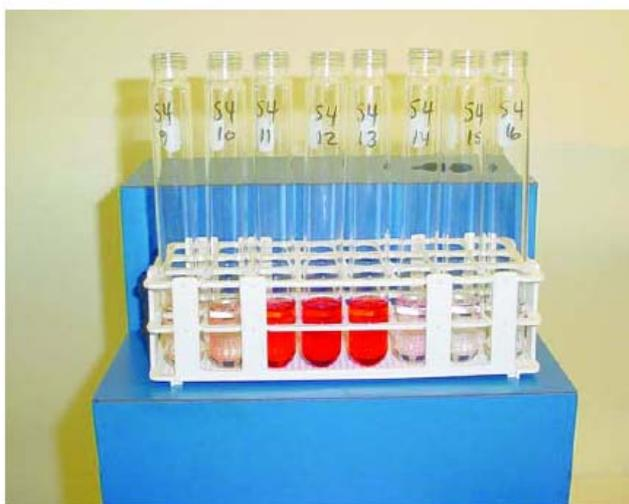
图6 采用一根填充了60克 Envirobeads SX-3 的玻璃 GPC 柱, 1: 1 的乙酸乙酯: 环己烷移动相洗脱出来苏丹4号, 流速为 5mL/min。苏丹4号主要收集于第11管到第13管, 对比收集于第4管到第7管的天然红辣椒色素和树脂。
