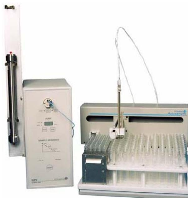
图 1 GPC AutoPrep 2000 系统配置 1096TB 型自动进样器
