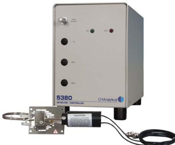
Figure 1. 脉冲式火焰光度检测器 (PFPD)，遵照 ASTM 方法 D4735 和 D7011 检测和定量苯中的噻吩
